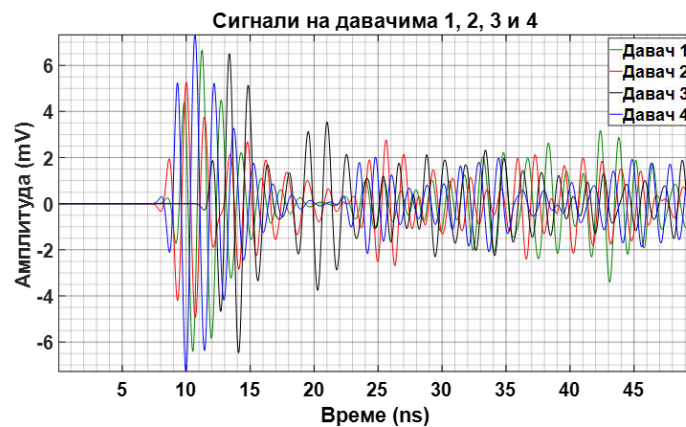
Слика 5 – Прикази сигнала парцијалних пражњења на давачима 1–4 у различитим бојама (зеленом на D_1 , црвеном на D_2 , црном на D_3 и плавом на D_4 ).
